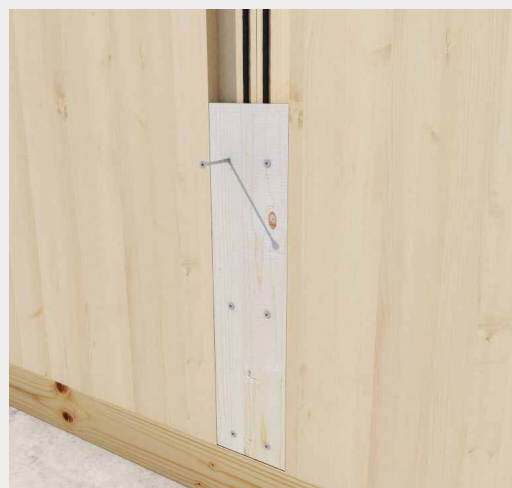
Fixare pereți din CLT cu șuruburi HBS cu diametrul de 6 mm.
